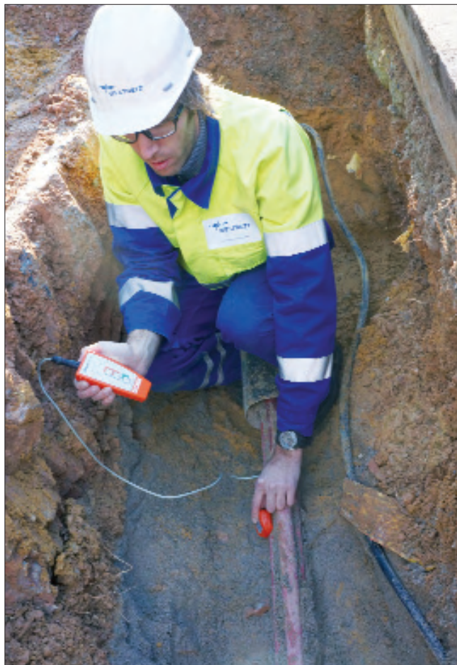
Bild 4: Unabhängig von der Polarität misst der Drallfeldsensor das erzeugte elektromagnetische Feld
