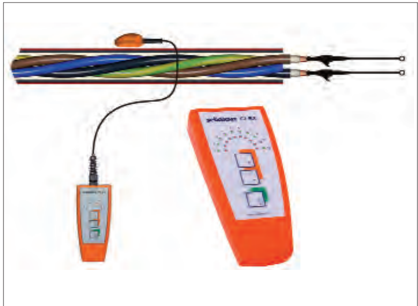
Bild 5: Auslesesicherheit: wenn nacheinander die rote und die grüne LED-Reihe aufleuchten, hat man das eindeutig richtige Kabel gefunden
