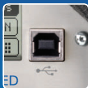
Firmware-Updates über rückseitige USB-Schnittstelle
