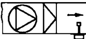
Filter bzw. Kühler beruhigen die Strömung.
