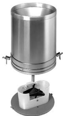
Zur Registrierung des Niederschlages ist das Messsystem mit einer Kippwaage ausgerüstet. Bei einer bestimmten Flüssigkeitsmenge kippt die Waage um, die eine Kippwaagenhälfte entleert sich, während sich die andere Hälfte füllt. Dieser Vorgang wiederholt sich fortlaufend. Der Inhalt beider Kippwaagenhälften ist konstant. Die Anzahl der Kippvorgänge ist ein Maß für die Niederschlagsmenge. Die Wippenumschläge werden elektronisch gezählt und in die Niederschlagsmenge umgerechnet.
