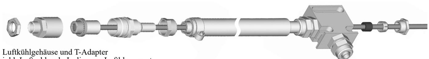
Luftkühlgehäuse und T-Adapter
