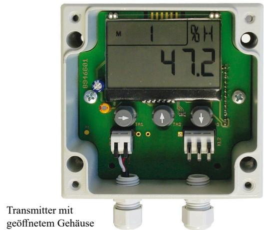
Transmitter mit geöffnetem Gehäuse
