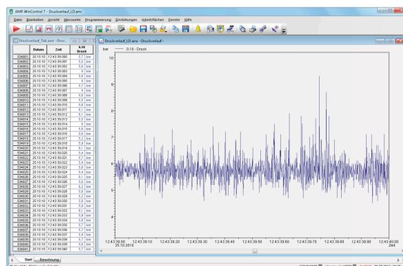
Die Gesamtgenauigkeit der Messung wird nur durch den Druck-Fühler mit dem angeschlossenen ALMEMO® D7-Messstecker bestimmt, unabhängig vom ALMEMO® Anzeigegerät/Datenlogger
