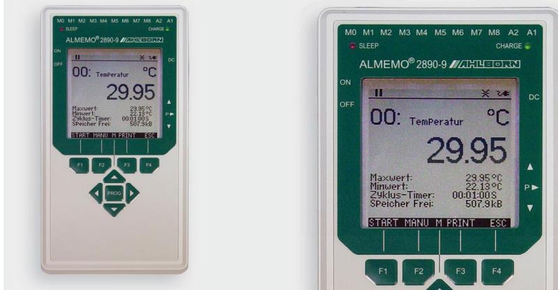
**ALMEMO® Präzisionsmessgerät mit Datenloggerfunktion umfangreiche Funktionen für alle Einsatzgebiete erhöhte Messgenauigkeit, schnelle Messrate. Große grafische Anzeige, helle Beleuchtung. 9 Messeingänge. Akkubetrieb, Ladung im Gerät.**
