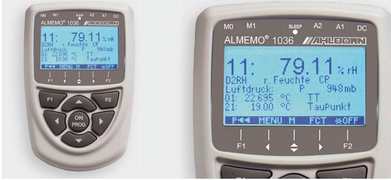
**Referenzmessgerät für Feuchte und Temperatur. Hochpräzise Messung mit Pt100-Psychrometer und Pt100-Fühlern. Auflösung Temperatur 0,001 K, Relative Feuchte 0,01 %, Taupunkt 0,01 K**
