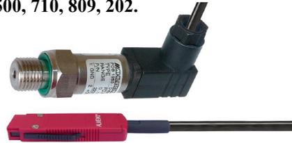
Der neue ALMEMO® D7-Messstecker ermöglicht hohe Messgeschwindigkeiten oder hohe Präzision, einsetzbar für die unterschiedlichsten Messaufgaben. Die Konfiguration erfolgt durch den Anwender ganz einfach am ALMEMO® V7-Messgerät.
