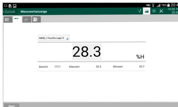
Mit Einzelmesswertanzeigen einzelne Messwerte überwachen
