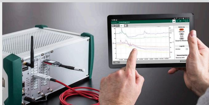
Einfache Programmierung und Visualisierung der Messdaten über Tablet
