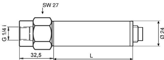
Typ **FD 8214** Standard-Ausführung, innenliegende Membran mit G1/4" Innengewinde.
