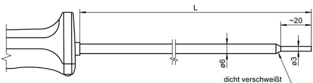
für Tauchmessung in plastischen, pastösen Medien z.B. Bitumen.
