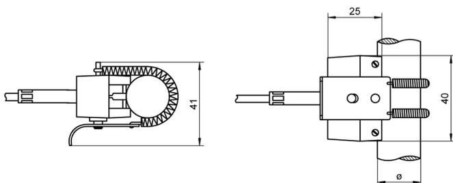
für Oberflächenmessung an Rohrleitungen
