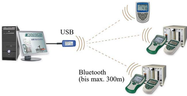
**Drahtlose PC-USB-Verbindung mit Bluetooth**
