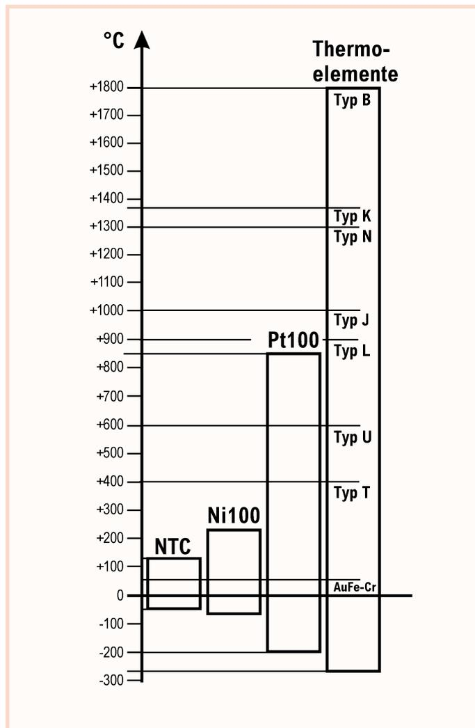
Welche Art Temperaturfühler Sie benötigen, hängt von Ihrer Messaufgabe ab. Grundsätzlich stehen Thermo-elemente, Widerstandssensoren (Pt100 und Ntc) und Strahlungsthermometer (Infrarotsensoren) zur Auswahl.
