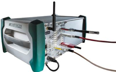
Messwerterfassunganlage, Bedienung am Tablet über App.
