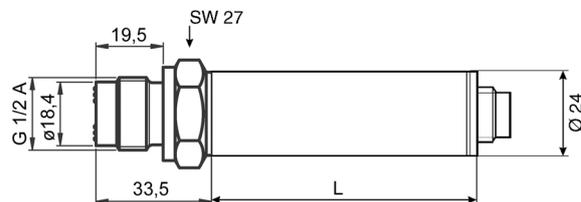
Typ **FD8214M** Frontbündige Membran (mit Gewindeende verschweißt), Außengewinde G1/2", leicht sterilisierbar
