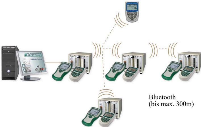
**Drahtlose Verbindung zwischen ALMEMO® Messgeräten mit Bluetooth**
