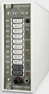
**Referenzmessgerät für Temperatur und Feuchte.**
