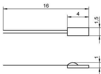
ungeschütztes Sensorelement zum Eigenbau von Fühlern
