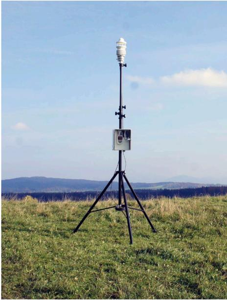
Universelle Wetterstation für mobilen Einsatz zur Messung von Windrichtung, Windgeschwindigkeit, Temperatur, Luftfeuchte, Luftdruck, Niederschlag, Globalstrahlung. Leicht zu installieren, robuste Ausführung, unterschiedliche ALMEMO® V7 Datenlogger möglich.
