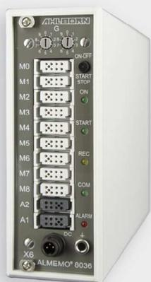
**Appareil de mesure de référence pour la température et l'humidité. Appareil de mesure multicanal à 9 entrées de mesure pour capteur Pt100 et psychromètre Pt100.**
