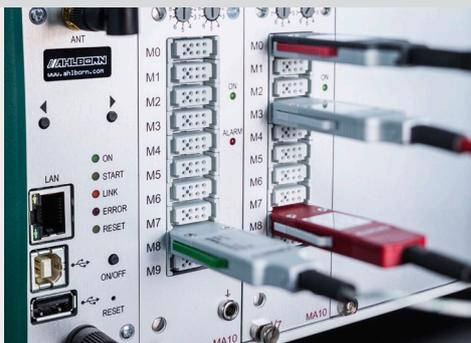
Connexions des capteurs ALMEMO® et pour la mise en réseau (témoin d'état OLED)
