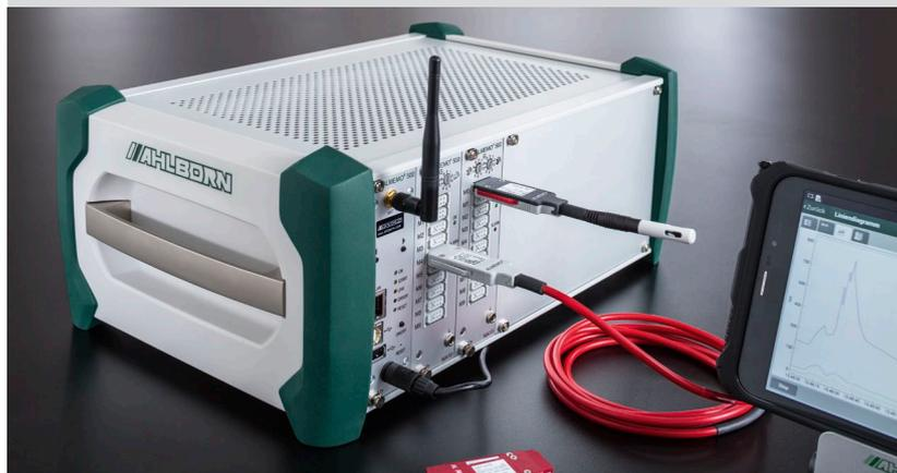
**Appareil de mesure de précision et centrale d'acquisition ALMEMO®, jusqu'à 90 entrées de mesure. De multiples fonctions pour tous les domaines d'application. Manipulation sur tablette par appli**
